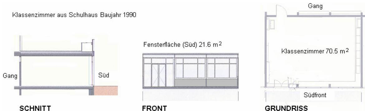
**Fig. 1.1:** Klassenzimmer, für das durch eine Messkampagne im Sommer 2004 und anschliessende dynamische Simulation die Modellparameter bestimmt wurden, so dass nun Massnahmen des sommerlichen Wärmeschutzes in ihrer Wirksamkeit untersucht werden können.
